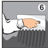
**6** Нанесите клей зубчатым шпателем. Уложите плитку в течение 10 минут после нанесения клея на основание. Выровняйте плитку в течение 10 минут.
