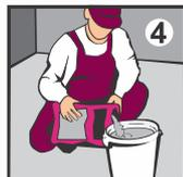
**4** Для подготовки раствора залейте водопроводную воду комнатной температуры в чистую ёмкость из расчёта 5,5-6,25 л воды на 1 мешок (25кг).
